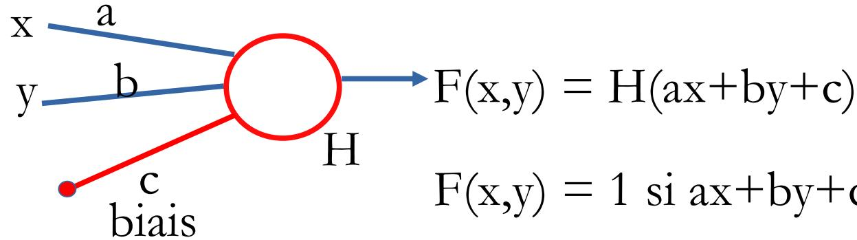
$$F(x,y) = 1 \text{ si } ax+by+c \geq 0 \text{ et zéro sinon}$$
