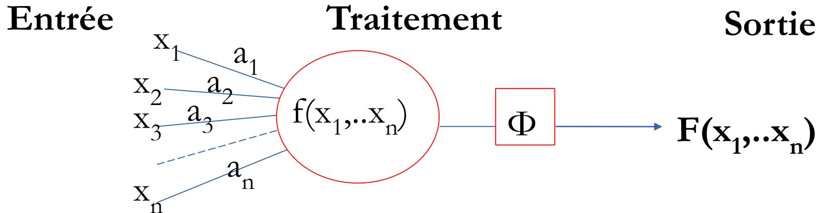
Plus simplement le neurone est caractérisé par ses coefficients, appelés poids, et sa fonction d'activation.
